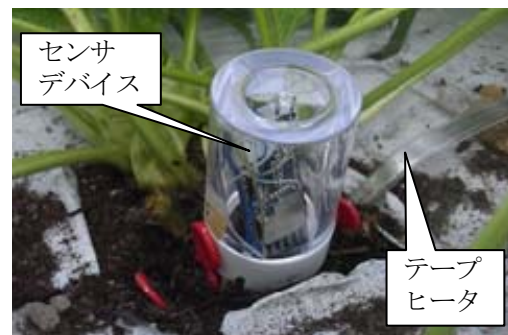
写真4 イチゴ株元へのテープヒータとセンサデバイスの敷設例
