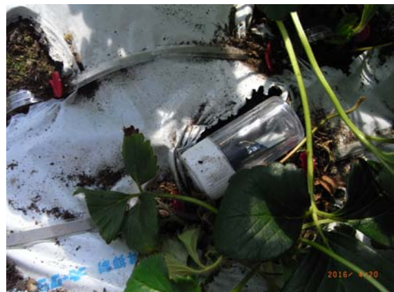
写真6 固定ピンが脱落したためにセンサデバイスが倒れた様子
