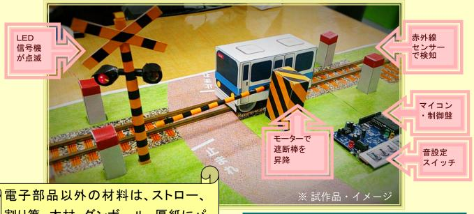
電子部品以外の材料は、ストロー、 割り箸、木材、ダンボール、厚紙にパ ソコンでプリントした紙など、身近なも のを使って作ります。
